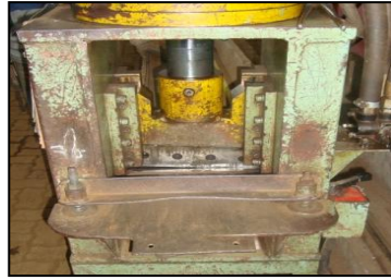
Figura 15 – Máquina de corte pesado sem barreira de proteção.
