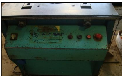
Figura 12 - Máquina com botão emergência, mas sem identificação.
